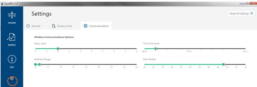
Simplemente mueva el control Address Range (Rango de direcciones) hacia arriba para aumentar las direcciones máximas de Modbus que se buscarán. Si ha buscado hasta la dirección 255 y aún no tiene conexión, haga clic en Troubleshooting (Solución de problemas) para solucionar los problemas, o comuníquese con Soporte Técnico de Seametrics para obtener ayuda.
