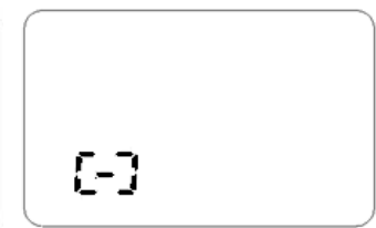
Medidor está instalado al revés
